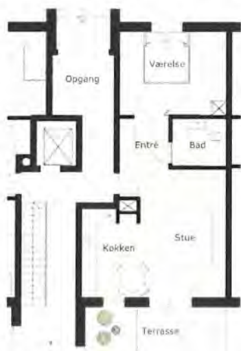
Planforslag - ny bolig i stueetage ved ombygget opgang. Planløsningen tilgodeser pladsbehov for en selvhjulpne kørestolsbruger. I alt 152 boliger indrettes efter tilgængelighedskriterier.
